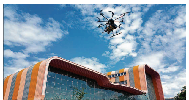
Der „Inspektokopter“ im Einsatz: Die Drohne soll aus der Luft Außenaufnahmen der Rotoren von Windkraftanlagen machen. Am Boden können Techniker dann mögliche Schäden erkennen. Foto: Hersteller
